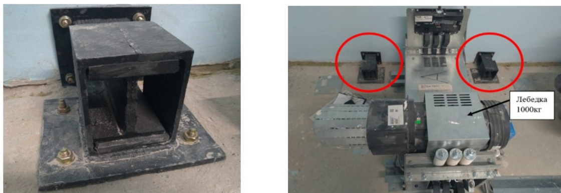
Рис. 8. Внешний вид и месторасположение упоров-ограничителей.
