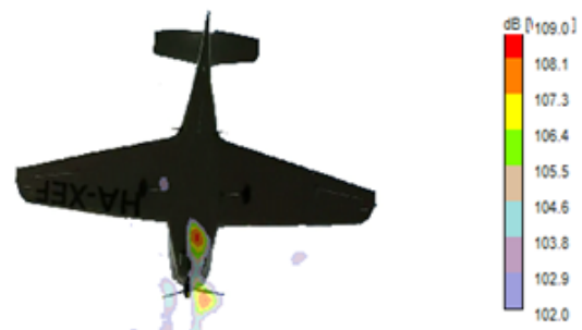
д) частотный диапазон 800–1200 Гц, в составе СУ поршневой двигатель
