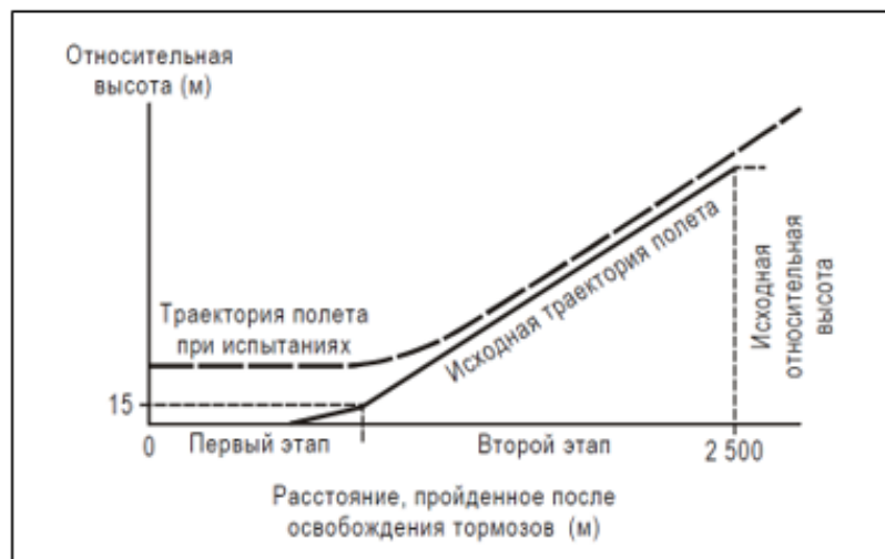
Рис. 4. Типичные профили при испытаниях (с имитацией взлета) и в исходных условиях, регламентируемых Главой 10 стандарта ИКАО
