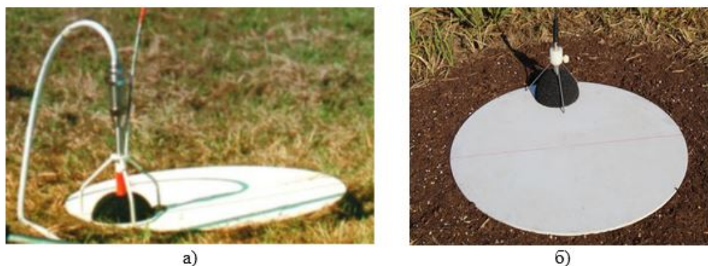
Рис. 5. Общий вид измерительного микрофона при выполнении сертификационных испытаний
