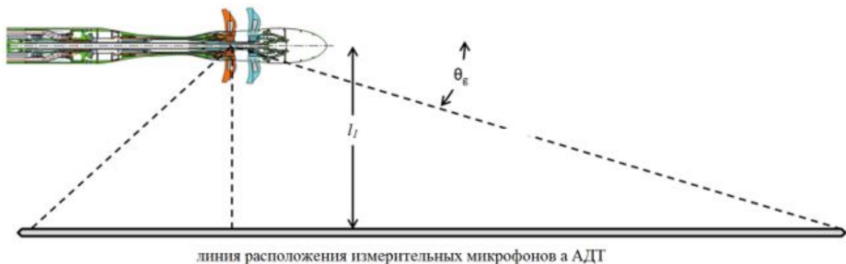
Рис. 8. Схема проведения эксперимента в АДТ для оценки уровня звуковой мощности источника (в данном случае «открытого ротора»)
