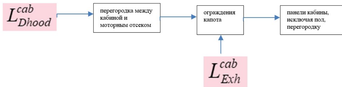
Рис. 1. Схема распространения звука от источников в кабину
