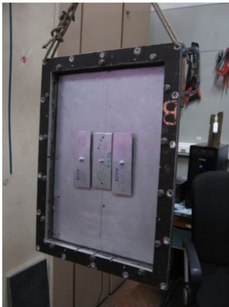
Рис. 3. Фото рамы и облицованной покрытием пластины с тремя резонирующими полосовыми вибропоглотителями
